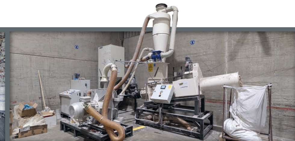
Mit der unscheinbaren neuen Anlage wird auch nassfestes Material recycelbar.
